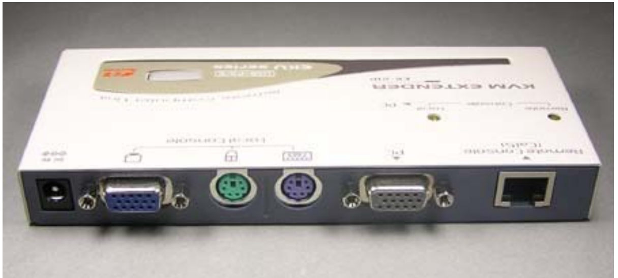
コンピュータユニットEKU-21Pのケーブル接続ポート
