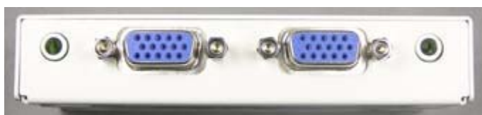
ローカルユニット(EVA12L)およびリモートユニット(EVA02R)のディスプレイOUTとオーディオOUT接続面
