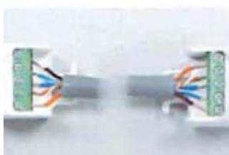
3. 各芯線の接続に間違いがないことを確認したのち、マイナスドライバーを用いて端子台のネジ(M2)をしっかりと締め、差し込まれた芯線を保持してください。
