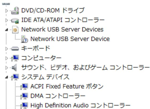
また、デバイスマネジャー上で、「ユニバーサルシリアルコントローラー」のツリー内に、「Network USB Device」があり、かつ「！」「？」などのマークが付いている場合は、セットアップが失敗していますので、再度ドライバーをセットアップする必要があります。
