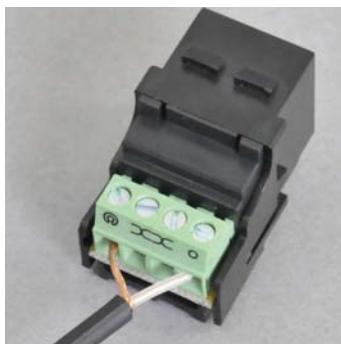
2. 商品図面に記載の結線図にしたがい、各芯線を端子台に差し込みます。
