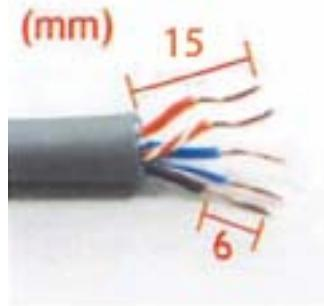
1. 使用する電線の被覆をむいて芯線を 15mm 程度引き出し、さらに芯線の被覆を 6mm 程度ストリップします。使用しない芯線やセパレータのあるケーブルの場合、それらは切り落としてください。
