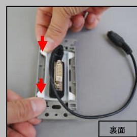
支点に中継AVコンセントモジュールを差し込んだら、反対側を押し込みます。
