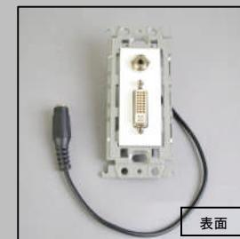
中継AVコンセントモジュールの取付完了です。
