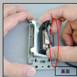
支点側に中継AVコンセントモジュールを差し込みます。
