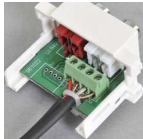
3. 各芯線の接続に間違いないことを確認したのち、マイナスドライバーを用いて端子台のネジ (M2) をしっかりと締め、差し込まれた芯線を保持してください。
