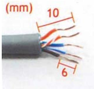
1. 使用する電線の被覆をむいて芯線を 10mm 程度引き出し、さらに芯線の被覆を 6mm 程度ストリップします。使用しない芯線やセパレータのあるケーブルの場合、それは切り落としてください。
