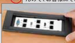
ネジ止め後、正面よりフェースプレートをパチンと音がするまで押し込んで取付完了です。
