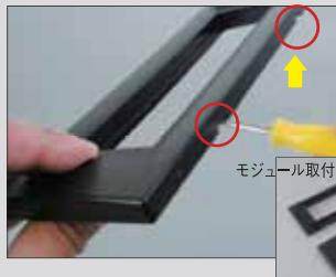
片側にある切り込み2点にマイナスドライバーを差し込みフェースプレートとモジュール取付部を分割してください。勘合しているツメ部が割れないようゆっくりと作業してください。
