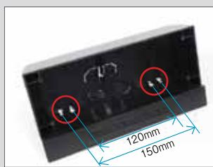
卓上ボックスは卓上ボックス底面に設けた4つの穴からM3ネジ2本で机上に固定することができます。
