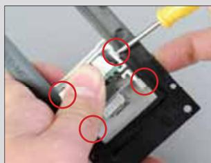
モジュール取付枠背面より45モジュールを支持するツメ4点を指やマイナスドライバーで押し込みながら45モジュールを正面側に押し戻してください。
