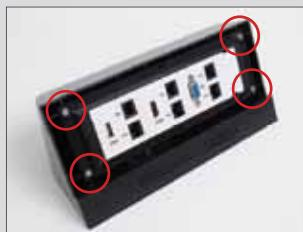
卓上ボックスとモジュール取付枠は4点の付属のネジ(M3タッピングネジ)で止めます。
