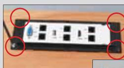
4点のネジ穴(M3)を使ってフェースプレート取付前のモジュール取付枠を板状パネルにネジで止めます。M3ネジは付属しておりませんので、お客様にてご用意ください。
