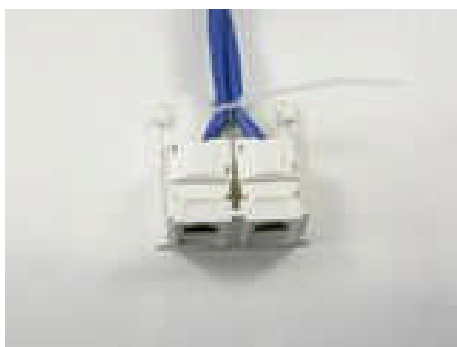
9.ケーブルの脱落を避ける為に、本体に結束バンドを通し、ケーブルと本体を結束します。
