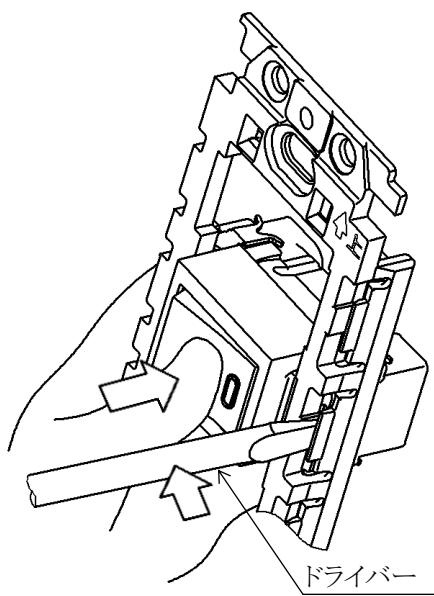
(注) ドライバーを回転させたり、強引に倒したりしますと、取付枠が破損する
