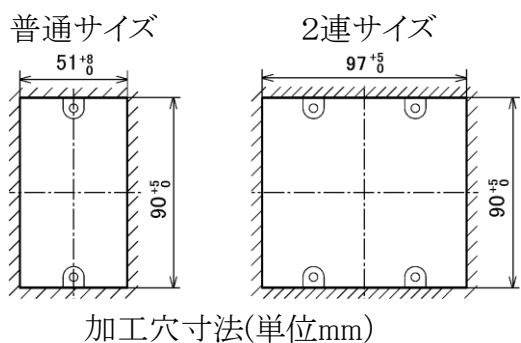
(注1) JIS適合以外のスイッチボックスを用いますと、ボックスカバーの穴の四隅に取付枠の垂下部が当たり入らない場合があります。
