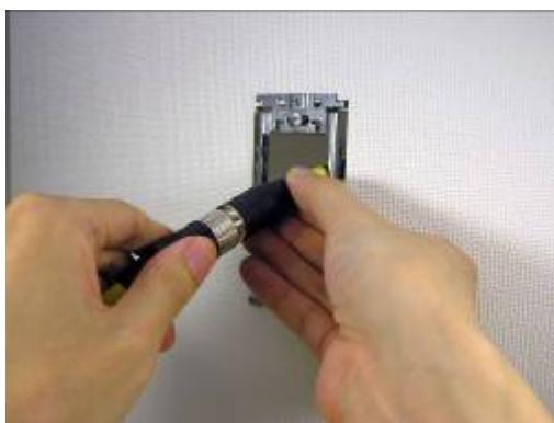
7. 中継ケーブルのネジ止めリングをしっかりと締めます。
